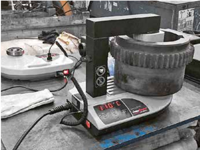
simatherm -induktiolämmittimet VOLCANO IH 025 ja IH 070 kahdella erikokoisella työkappaleella: IH 070 -malli (edessä) lämmittää hammaspyöräholkin haluttuun asennuslämpötilaan.
