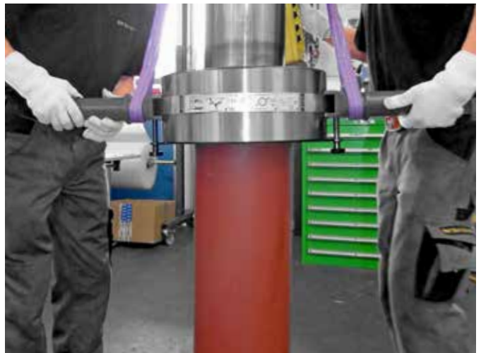
Bearing Handling Tool BHT -työkalu mahdollistaa, että painavat, esilämmitetyt rullalaakerit voidaan turvallisesti nostaa ja tarkasti asentaa turbiiniakselille.
