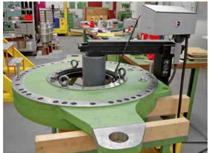
Suurinta ja tehokkainta simatherm -induktiolämmittintä IH 240 käytetään tässä lämmittämään tuuliturbiinin vaihteistolappaa.
