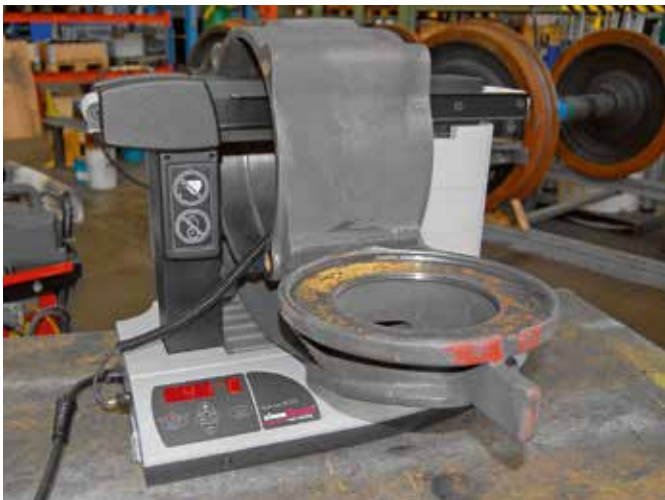
Junan telin asennus; tehokas IH 210 -induktiolämmitin lämmittää massiivisen laakeripesän jotta laakeri voidaan asentaa paikalleen.
