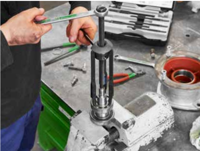
Bearing Puller BP 61 -ulosvetimen avulla kuulalaakerit irrotetaan akselilta helposti ja hallitusti.
