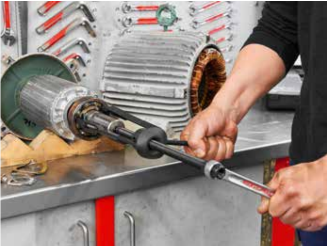
Twin Puller TP 150 -ulosvedin tekee sen: sähkömoottorin roottorin tiukasti paikoillaan oleva laakeri irrotetaan vaurioittamatta akselipesää.
