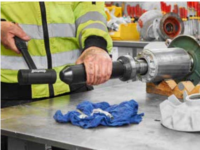
Fitting Tool FT 33 -asennustyökalu varmistaa, että asennusvoima jakautuu tasaisemmin laakerin sisä- ja ulkorenkaille ja eikä vioita vierintäosia.
