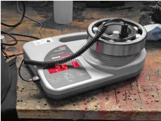
Helposti kannettava VOLCANO IH 025 painaa vain 3.5kg, mutta se lämmittää helposti jopa 10kg painavia osia +110°C asteeseen.
