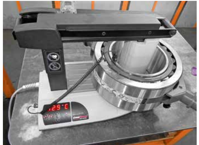
IH 210 -lämmittimen kelan ympärille asetettu rullalaakeri lämmitetään induktiolla. simatool -laakerinkäsittelytyökalu on asetettu jo paikalleen helpottamaan laakerin nostamista akselille, kun määritetty asennuslämpötila on saavutettu.
