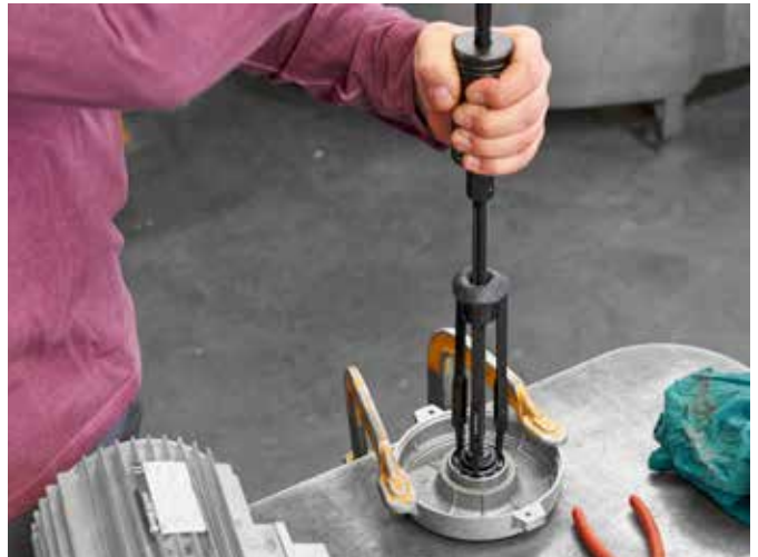
Maintenance Kit MK 10-30 -huoltosarja tekee sähkömoottorin päätylaipan pallolaakerin irrottamisesta helppoa.
