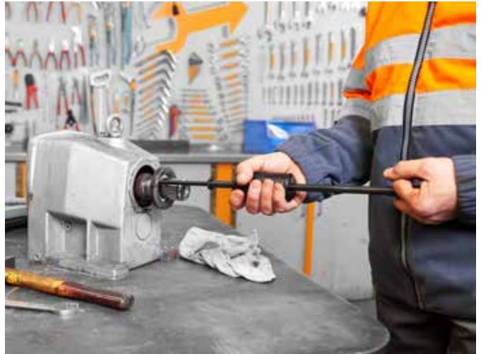
Seal Puller SP 50 -ulosvetimen käyttö irrotettaessa akseliivistettä vaihteistosta vaurioittamatta laakeripesää tai akselia.
