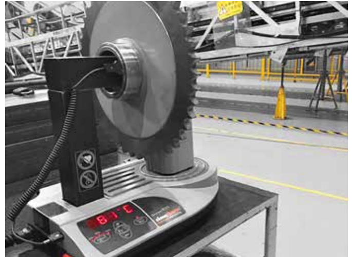
IH 070 -induktiolämmitin on oivallinen valinta lämmittämään liukuportaiden voimansiirtoketjun hammaspyörää.
